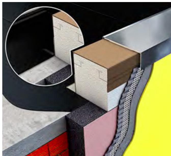
Ak sa prvak lepí na existujúcu parozábranu, musí byť zabezpečená prídržnosť k podkladu. Pri montáži Austrotherm Atikového prvku, ako je znázornené na obrázku, nesmie byť lepená styková plocha (min. 50 % menšia ako prečnievajúca časť (celková hrúbka ETICS)).
