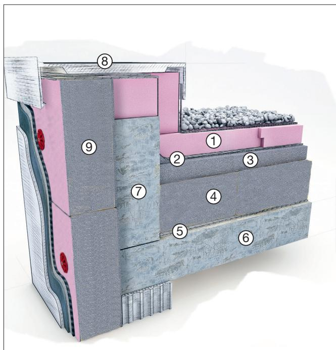
Štandardná metóda zhotovenia atiky pomocou betónových debniacich tvárníc a dodatočných teploizolačných prvkov
